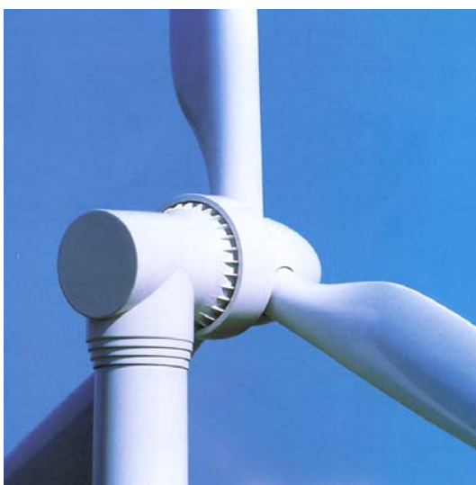
Figura 13. Aerogenerador con generador síncrono de imanes permanentes de flujo radial de 660 kW de potencia (GENESYS) y axial de 750 kW (JEUMON J48)
